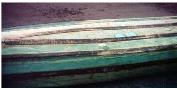
Рис.1 – Латки должны быть округленной формы.
