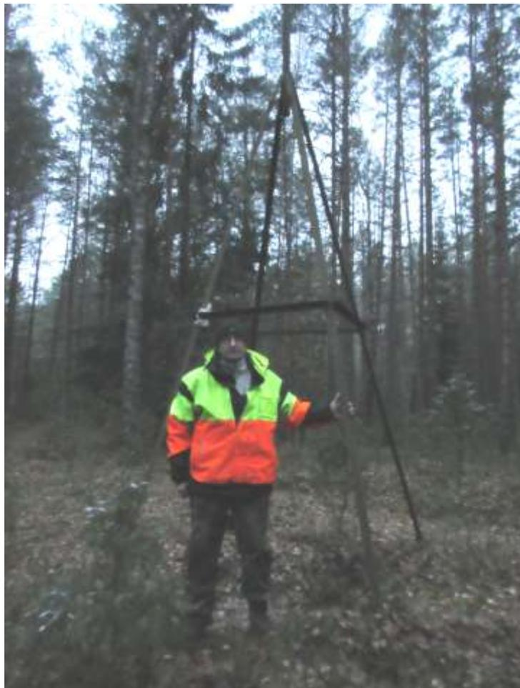
Металлический триангулятор на геодезической отметке 169.7м
