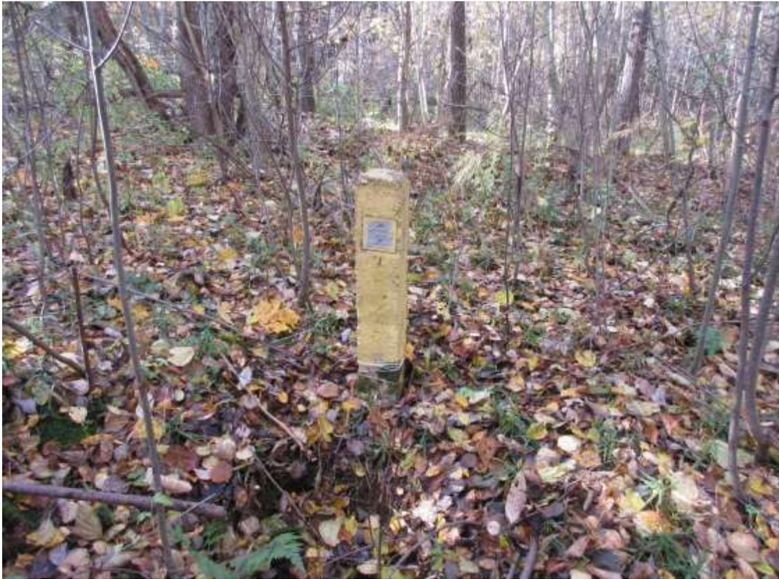
Геодезическая отметка высоты 145.0 м (Схема 4)
